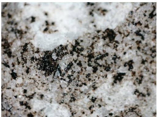
Fot. 19,20 Nawarstwienia na fragmentach marmurowej oprawy podstawy ambony zdj. mikroskopowe w pow. x 20
