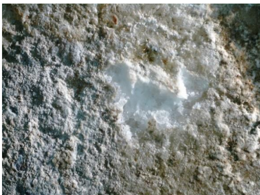
Fot. 15,16 Osłabiona partia przy powierzchni kamienia i przełam kamienia zdj. mikroskopowe w pow.x20
