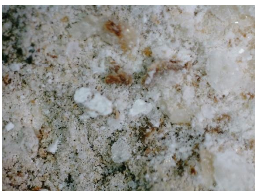
Fot. 23,24 Nawarstwienia żelaziste na elementach z lapidarium zdj. mikroskopowe w pow. x 20 i 250
