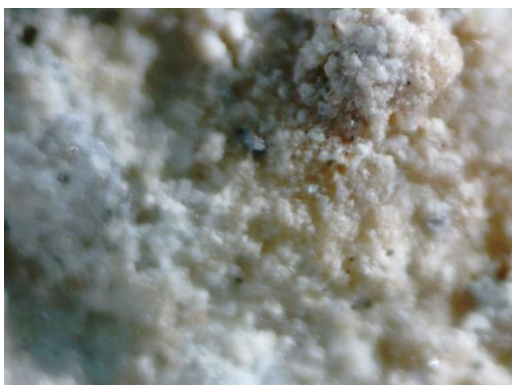
Fot. 13,14 Nawarstwienia węglanowe na kamieniu zdj. mikroskopowe w pow.x20
