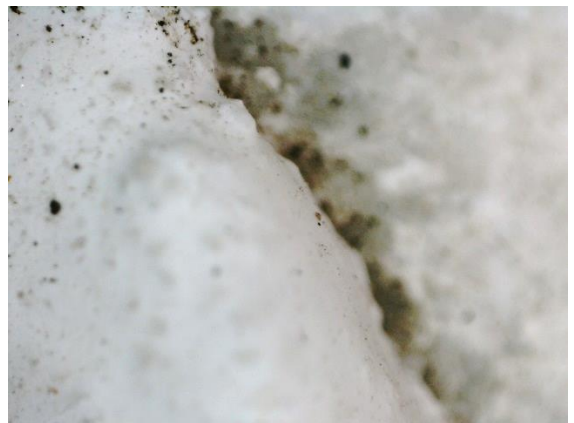
Fot. 25, 26. Zdjęcia mikroskopowe (pow.x20) próbki P7 – baza oprawy arkady ambony
