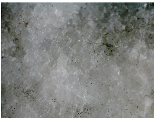
Fot. 15,16 Osłabiona partia przy powierzchni kamienia i przełam kamienia zdj. mikroskopowe w pow.x20
