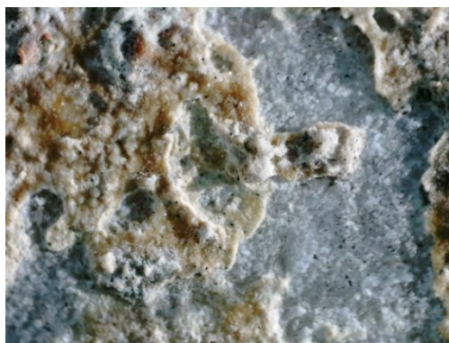
Fot. 13,14 Nawarstwienia węglanowe na kamieniu zdj. mikroskopowe w pow.x20
