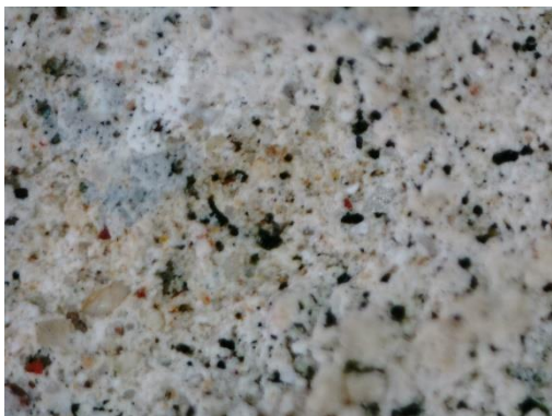
Fot. 11,12 Powierzchnia marmuru pokryta produktami korozji, i przełam , zdj. mikroskopowe w pow. x20
