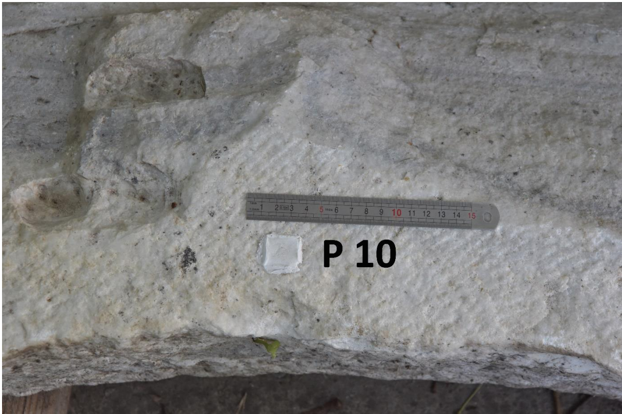
Fot. 12. Fragment marmurowej oprawy arkady ambony. Lokalizacja próbki P10
