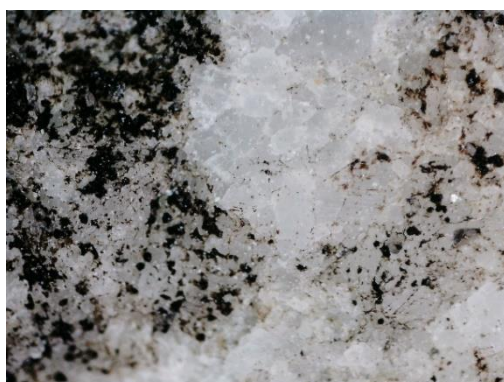
Fot. 19,20 Nawarstwienia na fragmentach marmurowej oprawy podstawy ambony zdj. mikroskopowe w pow. x 20
