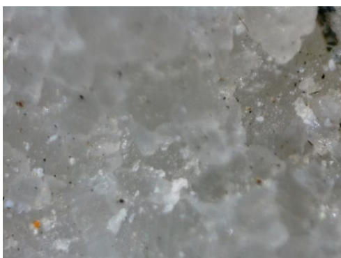
Fot. 9,10 Powierzchnia marmuru w przełamie i nawarstwienia, zdj. Mikroskopowe w pow.x20 i x 250
