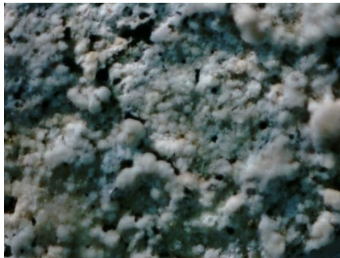
Fot. 9,10 Powierzchnia marmuru w przełamie i nawarstwienia, zdj. Mikroskopowe w pow.x20 i x 250
