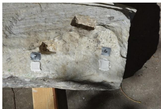
Fot. 27,28 Próbkki testowe zapraw aplikowane na elementach ambony w różnych lokalizacjach
