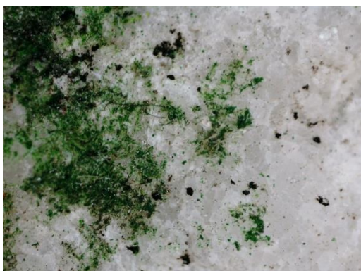
Fot. 21,22 Nawarstwienia biologiczne na elementach z lapidarium zdj. mikroskopowe w pow. x 20
