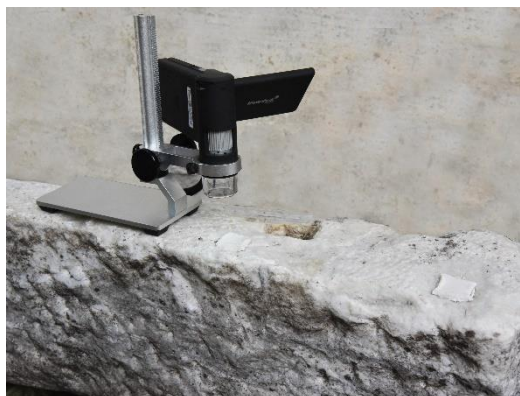
Fot. 5. Badania mikroskopowe próbek testowych zapraw do prac konserwatorskich
