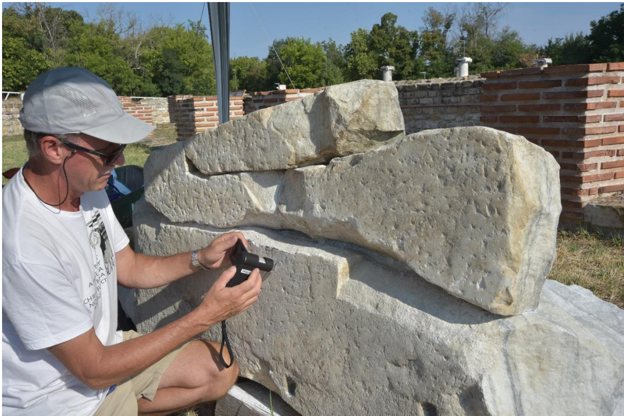
Fot. 61 Badania mikroskopowe nawarstwień i śladów narzędzi kamieniarskich
