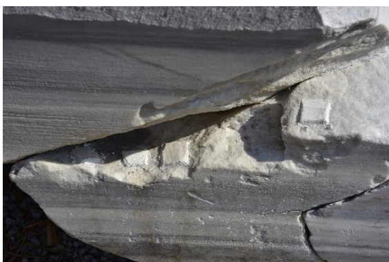
Fot. 27,28 Próbkki testowe zapraw aplikowane na elementach ambony w różnych lokalizacjach
