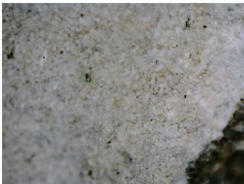
Fot. 7,8 Powierzchnia marmuru pokryta produktami korozji, zdj. Mikroskopowe w pow.x20 i x 250
