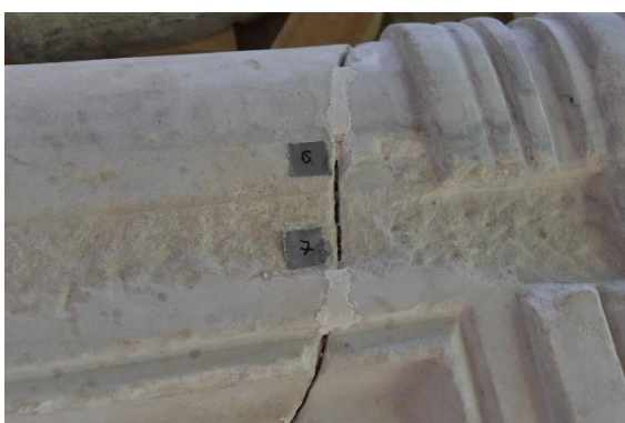
Fot. 29,30 Próbkki testowe zapraw aplikowane na elementach ambony w różnych lokalizacjach
