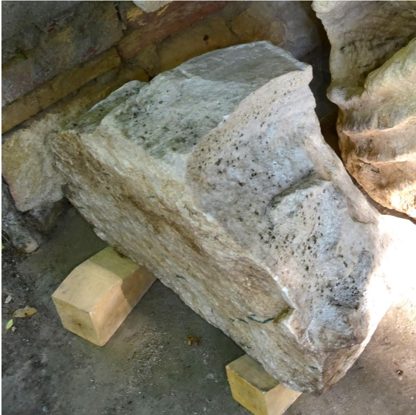
Fot. 23 Fragment marmurowego kapitelu po oczyszczeniu powierzchni
