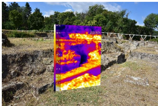
Fot. 3 Badania termowizyjne wybranej strefy murów w armamentarium
