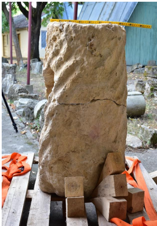
Fot. 27 i 28 Fragmenty spiralnie dekorowanej wapiennej kolumny, w trakcie konserwacji
