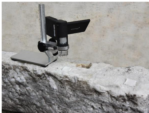
Fot. 5. Badania mikroskopowe próbek testowych zapraw do prac konserwatorskich
